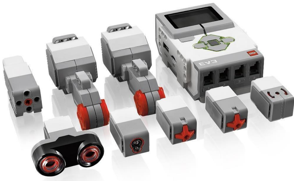
Рисунок 3. Электронные компоненты набора EV3
