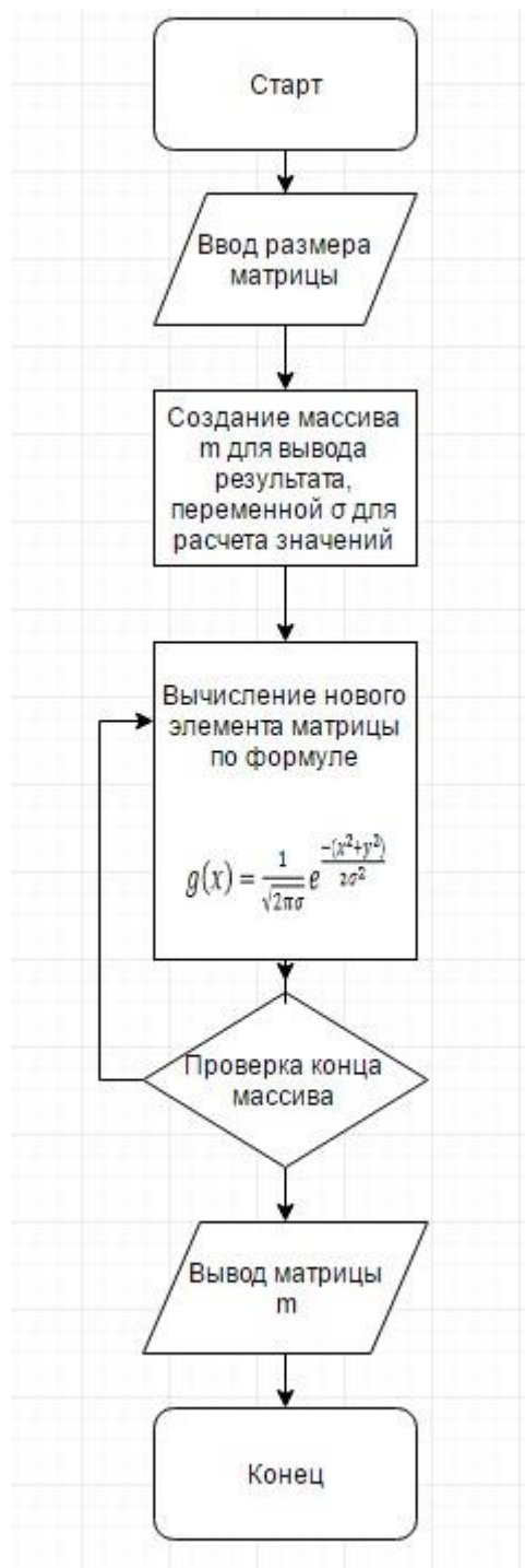
Рис. 6 – Блок-схема создания матрицы Гаусса
