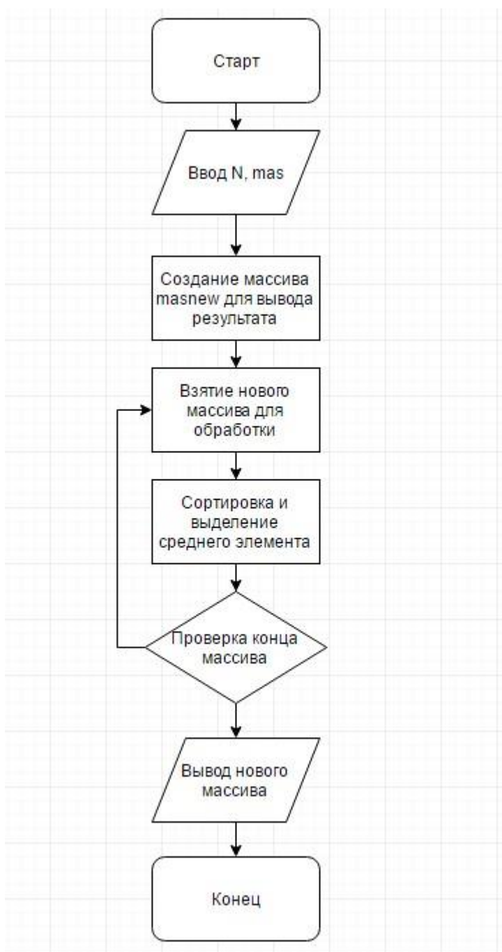
Рис. 5 – Блок-схема медианного фильтра
