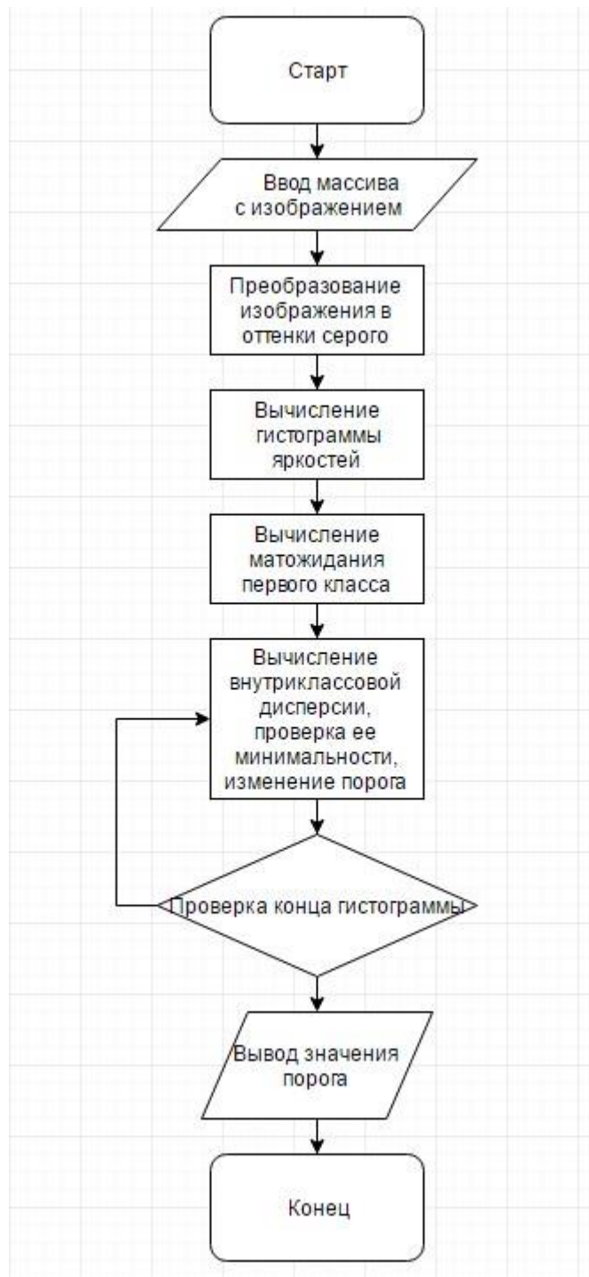
Рис. 8 – Блок-схема метода Оцу
