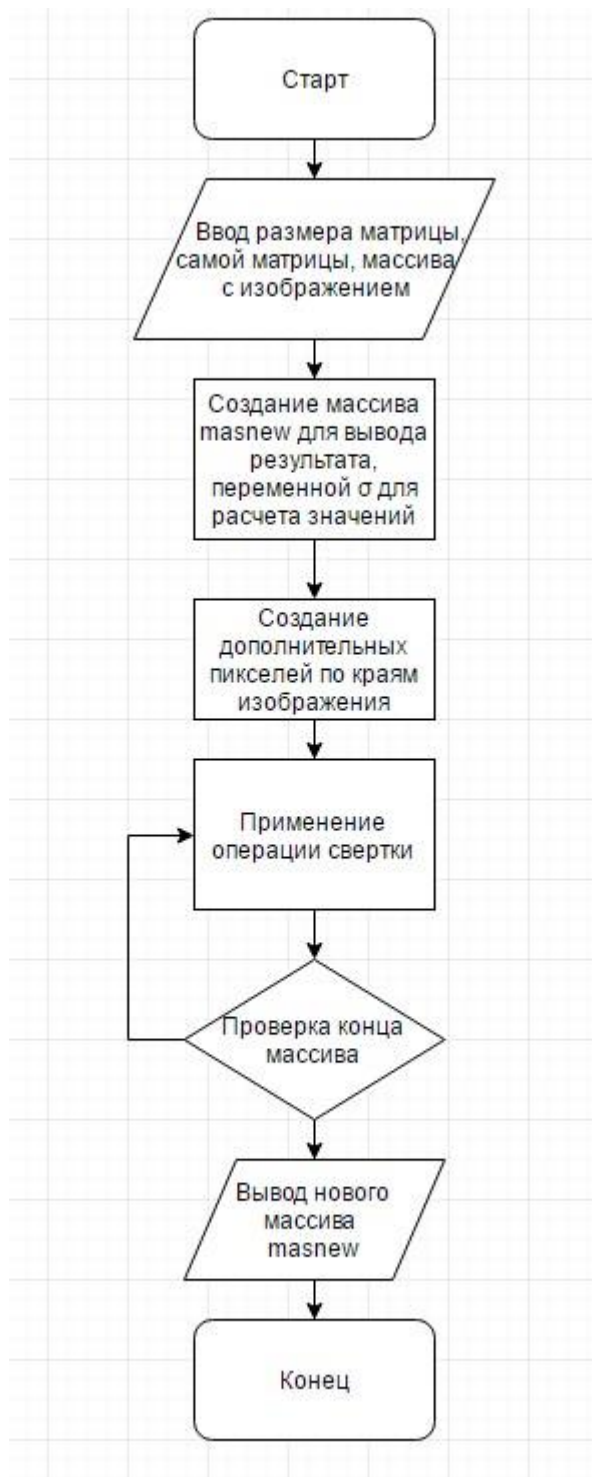
Рис. 7 – Блок-схема фильтра Гаусса
