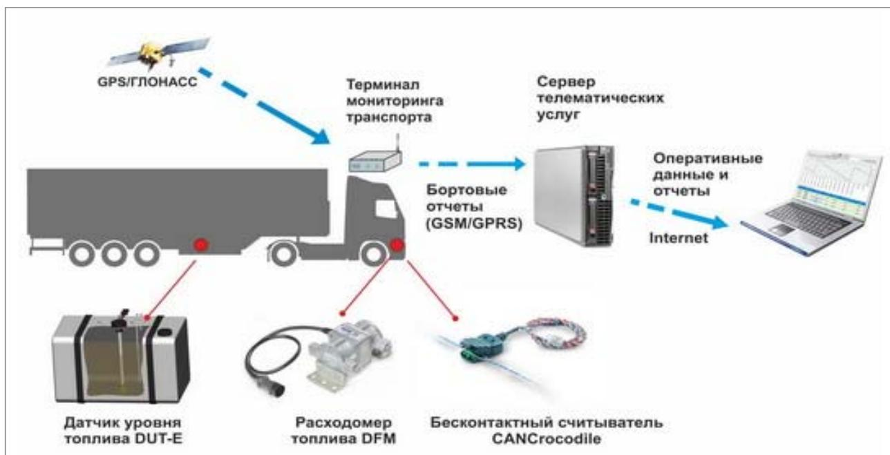
Рисунок 3.1 - Схема работы системы контроля работы транспорта
