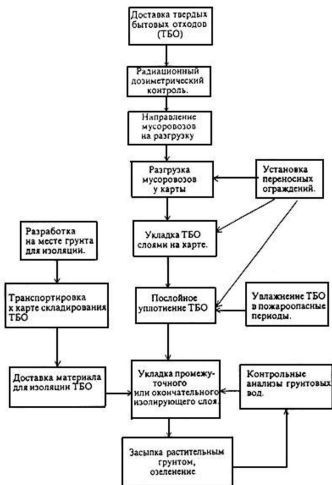
Рисунок 2 - Схема основных технологических операций при эксплуатации полигонов [26]
