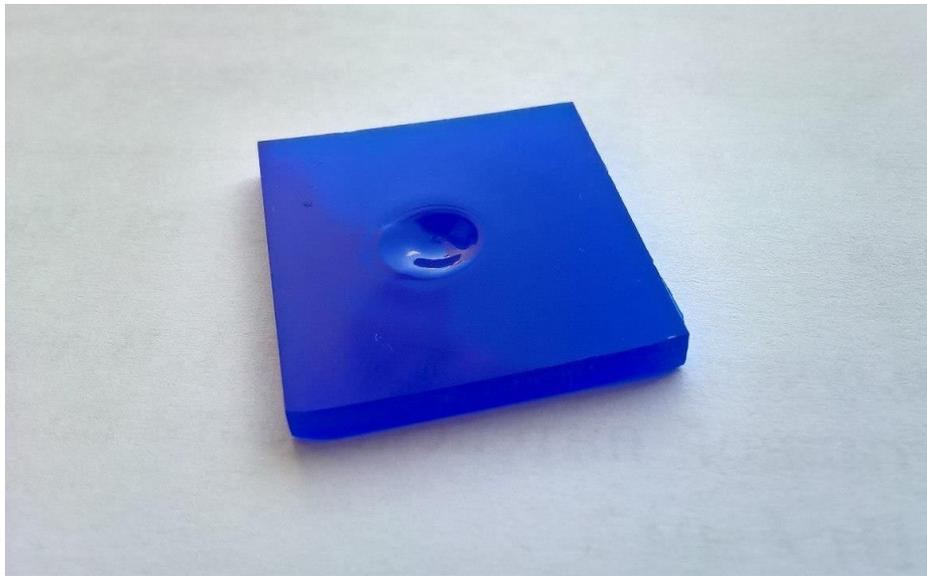
Рис.3.9. Эталон, изготовленный из оргстекла методом горячего прессования.
