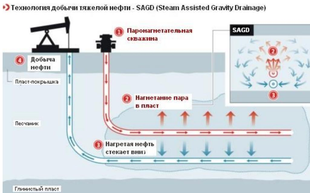
Рисунок 1.7. Технология парогравитационного дренирования пласта [25]
