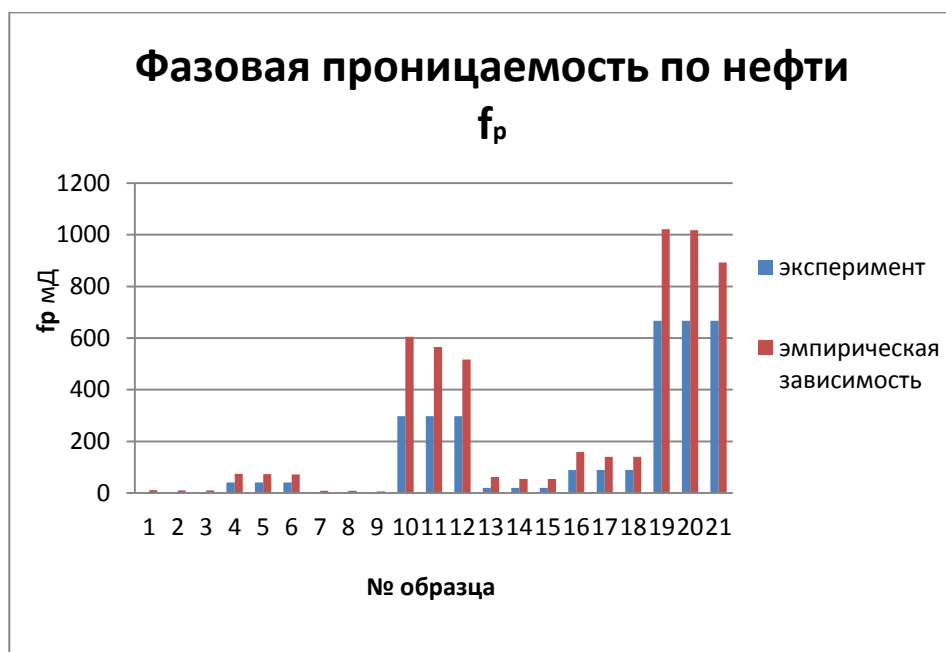
Рис 3.4 – Гистограмма сравнения данных проницаемостей по нефти при остаточной водонасыщенности полученной экспериментальным методом и с помощью эмпирической зависимости. Относительная погрешность составила 44,6%
