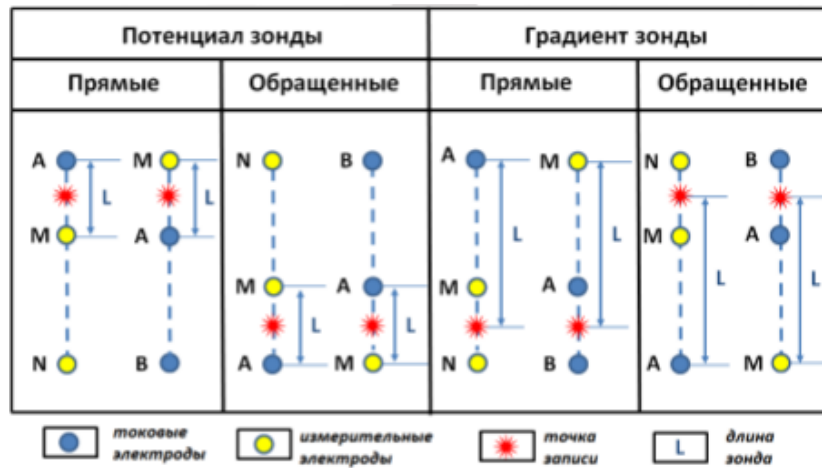
Рис.1.10 Типы зондов КС
