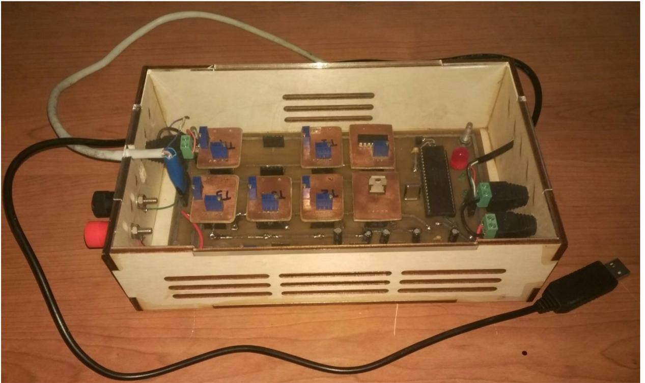
Рисунок Б.5. Реальные фото готовой автоматизированной системы сбора данных с установленными функциональными блоками: 5 функциональных блоков датчиков температуры, функциональный блок датчика давления и функциональный блок управления нагрузкой
