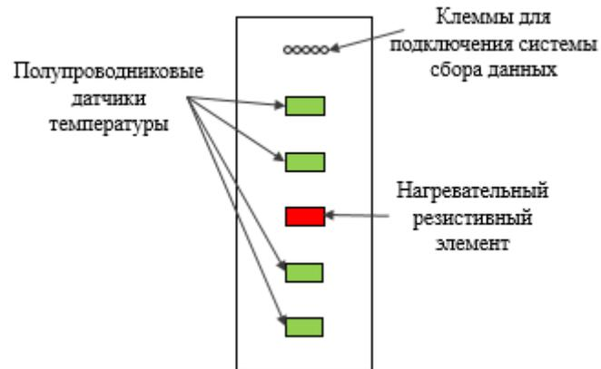
Рис. 2.10. Расположение активных элементов на линейке измерения
