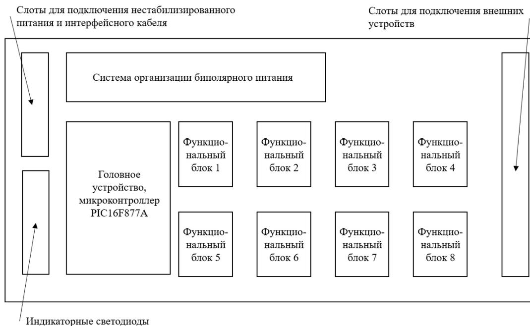
Рис. 2.3. Обобщенная структурная схема универсального микроконтроллерного блока
