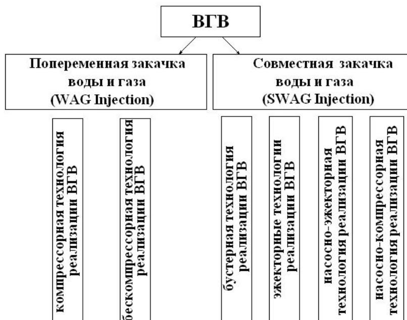
Рисунок 1.10 Классификация технологий водогазового воздействия на пласт
