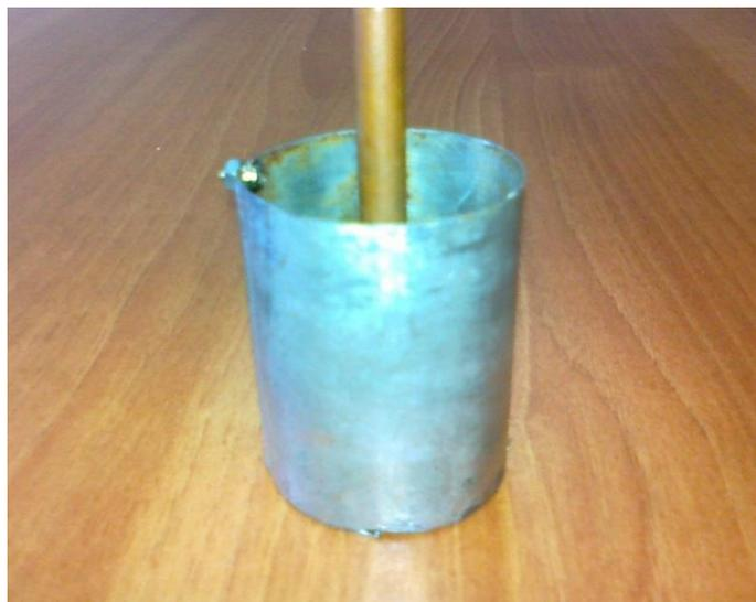
Рисунок 2.3 – Цилиндрический конденсатор
