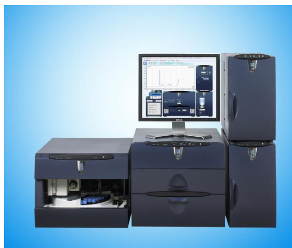
Рис. 2.4. «Капель 105» (а) и ионный хроматограф «Dionex ICS 2100» (б)
