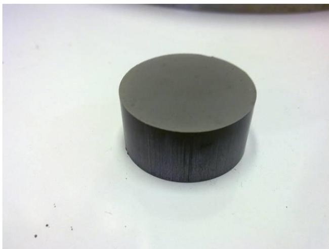
Рис.9. Образец таблетированного набухающего материала
