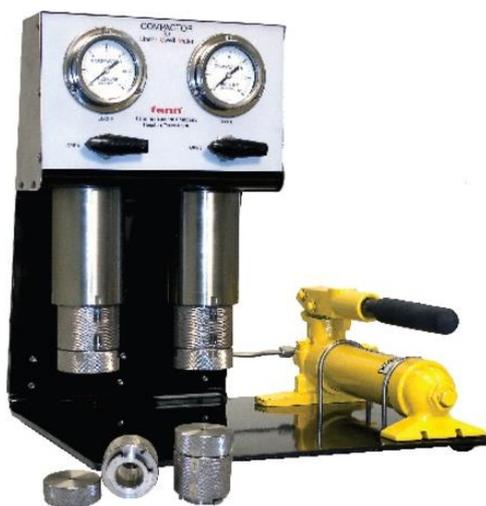
Рис.8. Гидравлический пресс для формирования таблетированного набухающего материала
