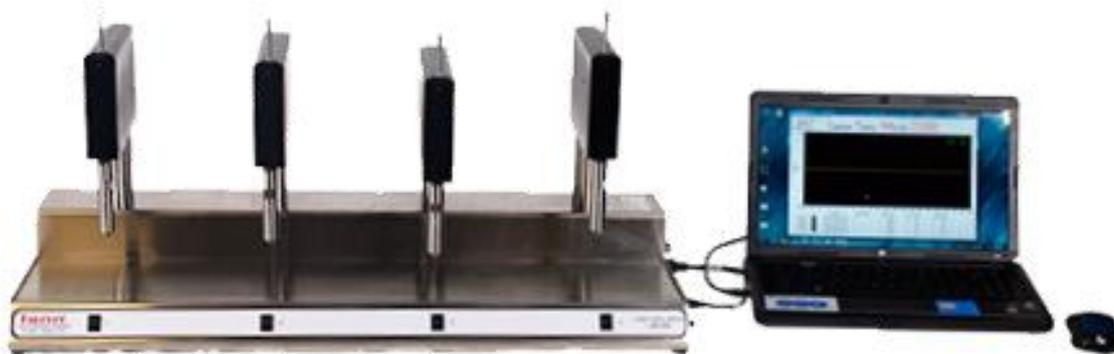
Рис.7 Внешний вид измерителя линейного набухания
