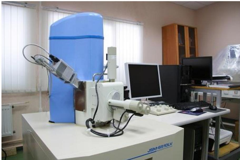
Рис 2.7 Растровый электронный микроскоп JEOL JSM-6510LV
