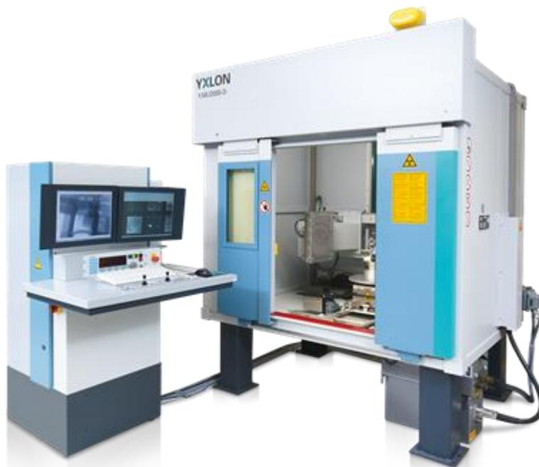
Рис. 2.14. Промышленный рентгеновский томограф YXLON MU2000-D
