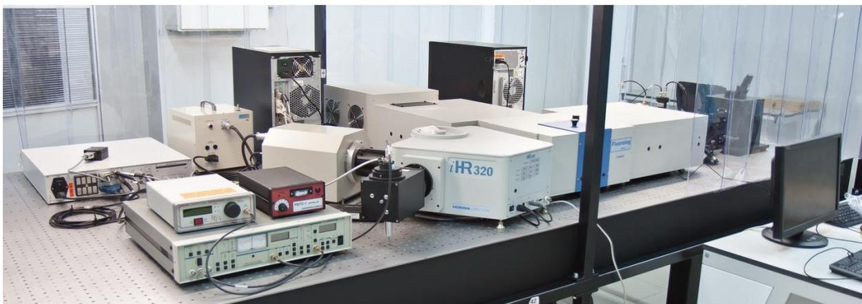
Рис 2.11. Спектрофлуориметр Fluorolog-3 (Horiba Jobin Yvon)
