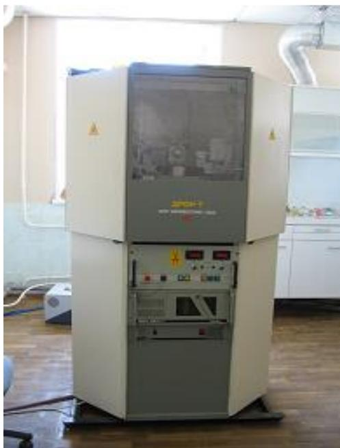
Рис. 2.3. Дифрактометр «ДРОН-7»
