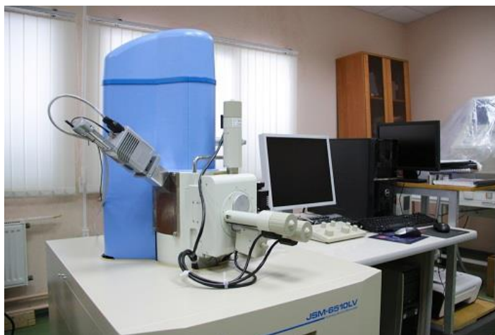
Рис 2.2 Растровый электронный микроскоп JEOL JSM-6510LV
