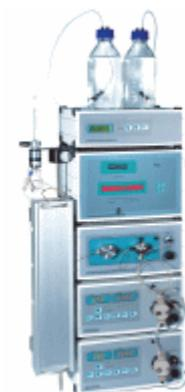
Рис.2.1. Жидкостной хроматограф «Стайер»
