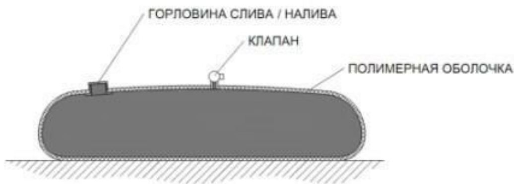
Рис. 1.1. Мягкий резервуар в заполненном состоянии По
