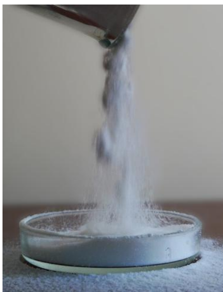
Рис. 2.10 “Сухая вода” с содержанием стабилизатора R202 5 мас. %
