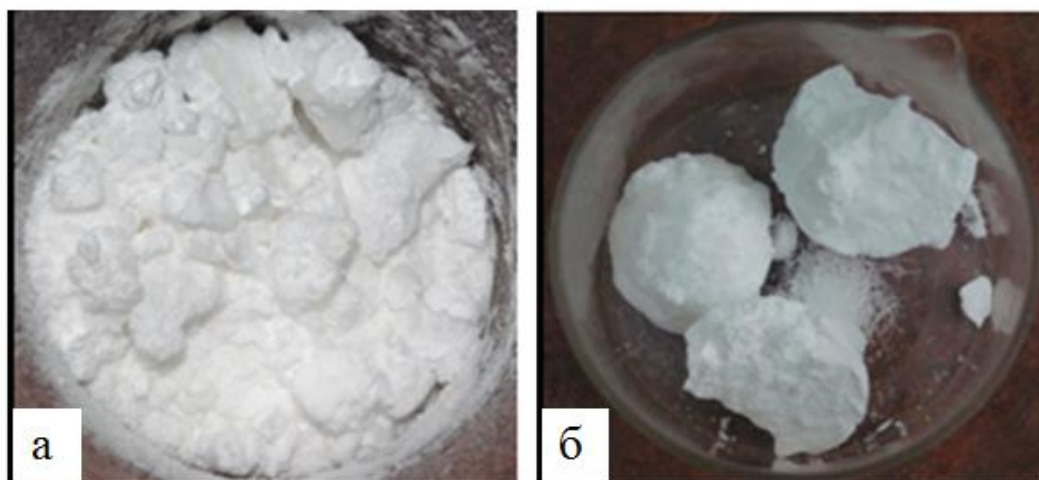
Рис. 1.1 Синтетические гидраты природного газа, полученные из дисперсного льда (а) и полусферических заготовок льда (б) [38]
