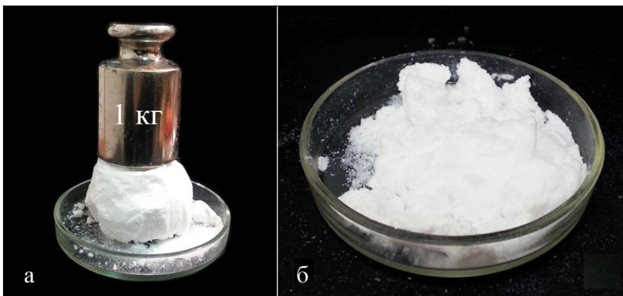
Рис. 3.18 Образцы гидрата метана, полученные в “сухой воде” с содержанием R202 5 мас. % (а) и 15 мас. % (б), сразу после извлечения из реактора. Температура -5^{\circ}\text{C} .
