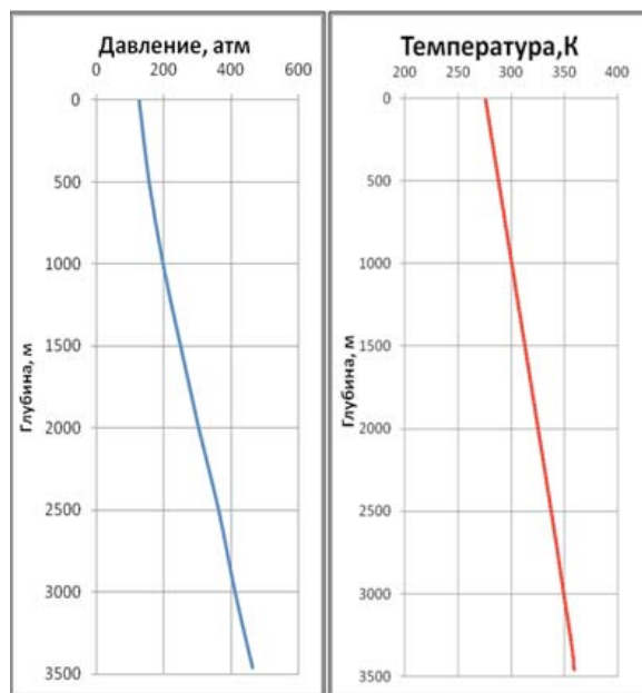
Рис. 1. Распределение давления и температуры в действующей скважине по глубине скважины
