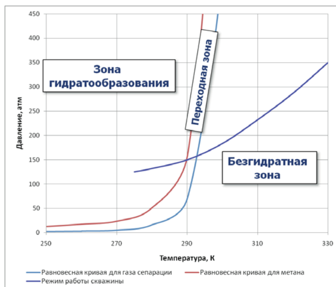
Рис. 3. Зоны образования газовых гидратов и график режима работы скважины
