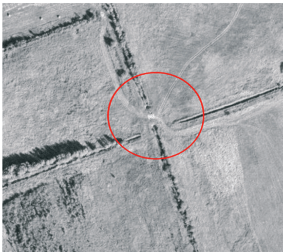
Рис. 5. Перекрытие каналов осушительной сети земляными дамбами по материалам АФС
