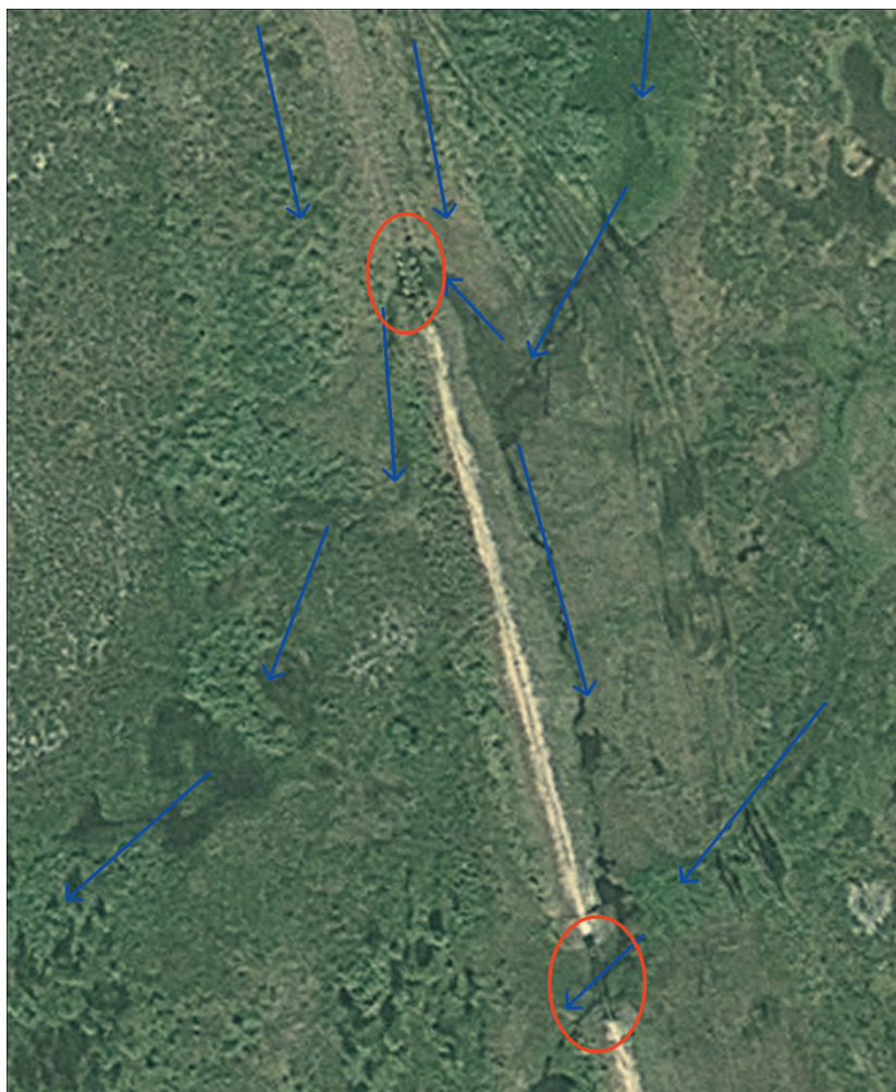
Рис. 1. Участок смены типов прокладки газопровода: подземного (вверху) и наземного (средняя часть). Стрелками показано направление стока, красным цветом выделены зоны разгрузки вод через МГ
