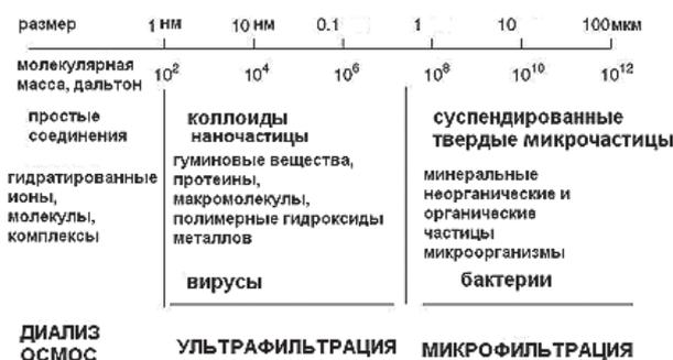
Рис. 1. Размерный ряд разделяемых компонентов и варианты мембранных методов их выделения
