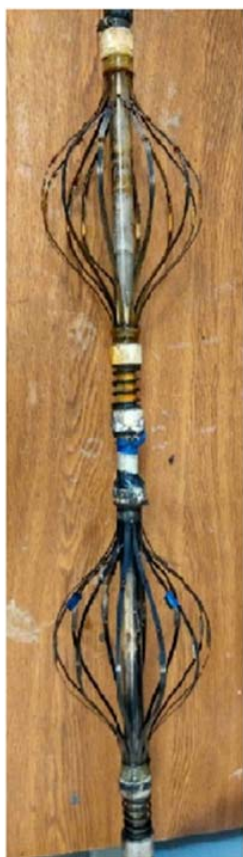
Рис. 5. Модернизированный азимутально распределенный температурный зонд
