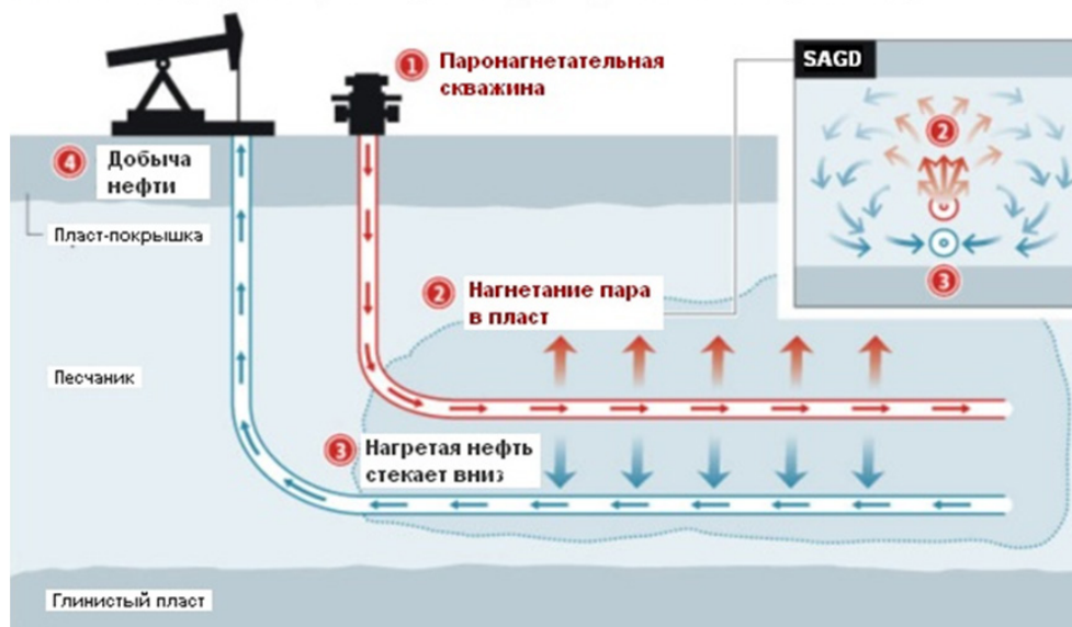
Рис. 1. Схема действия SAGD [3]
