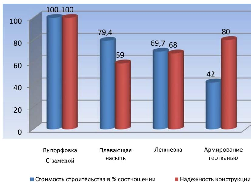
Рис. 11. Надежность и стоимость традиционных и предлагаемых конструкций насыпей на болотах
