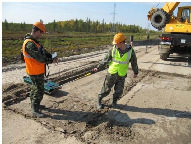
Рис. 5. Мониторинг экспериментальных участков с помощью георадарного зондирования
