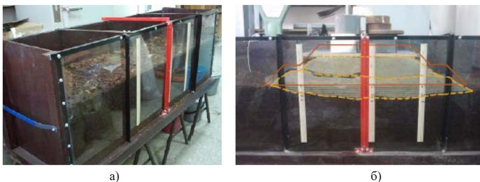
Рис. 2. Внешний вид лабораторных установок: а) лабораторный лоток по исследованию осадки и сроков консолидации торфяных оснований; б) установка для лабораторных испытаний предлагаемых конструкций
