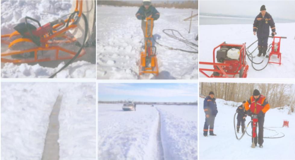
*Рис. 3.* Комплекс гидравлического ледопильного оборудования в работе
