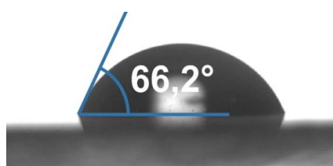
Рис. 5. Смачивание водой поверхности орг. стекла
