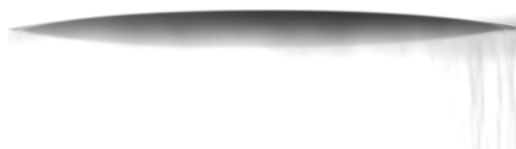
Рис. 12. Смачивание бромнафталином поверхности орг. стекла с адсорбированными УВ (дизельное топливо — 45% НКПР)
