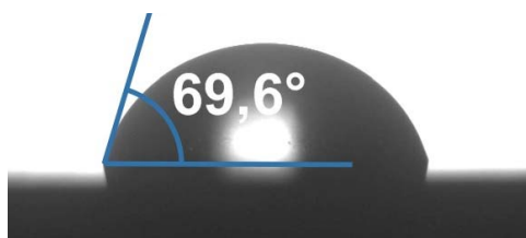
Рис. 6. Смачивание водой поверхности нерж. стали
