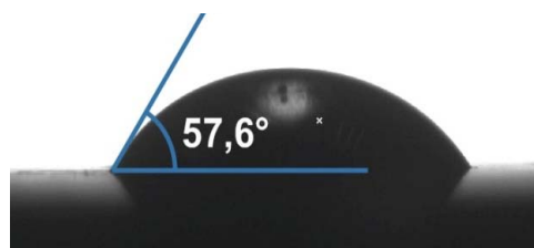
Рис. 11. Смачивание бромнафталином поверхности политетрафторэтилена
