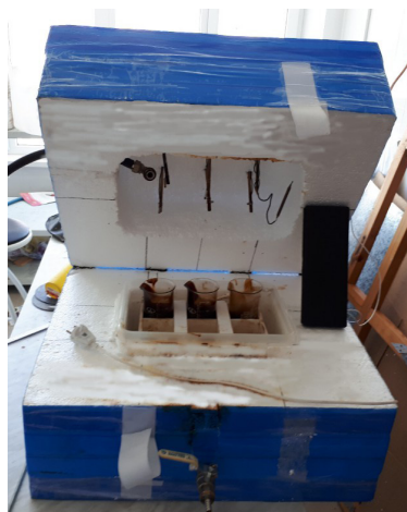
Рис. 4. Устройство для определения скорости осаждения АСПО в открытом виде
