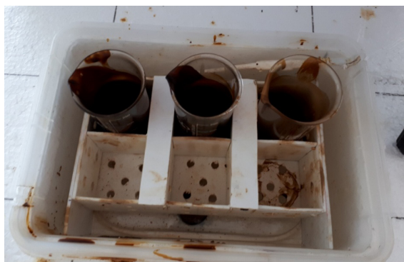
Рис. 5. Короб с перфорациями и опытными образцами АСПО
