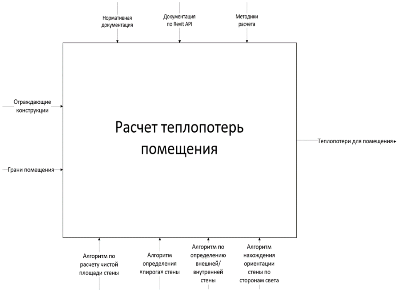
Рис. 2.1. Процесс расчета тепловых потерь помещения
