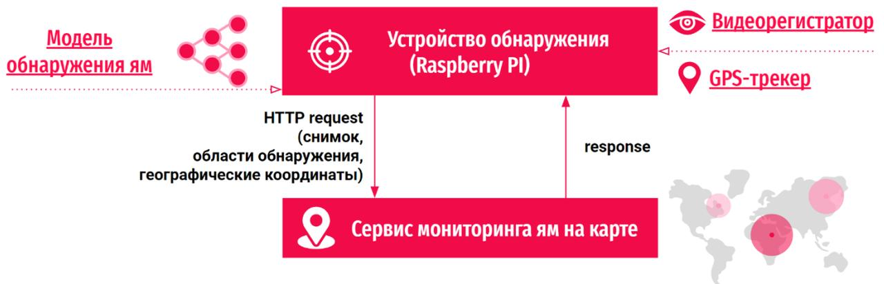
Рисунок 20. Архитектура программно-аппаратной системы мониторинга неровностей дорожного покрытия.
