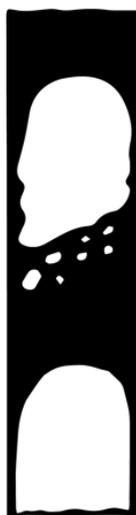
Рис. 3. Снарядный (пробковый) режим течения жидкости
