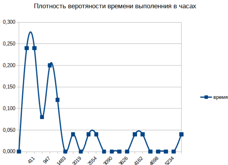
Рис. 2. Функция плотности вероятности распределения количества времени, требуемого на ремонт детали
