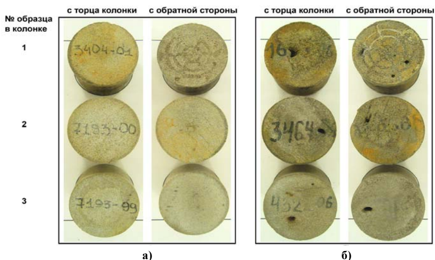
Рис.4. Торцевая поверхность образцов керна моделей пласта ЮС 2 после обработки составом стандартной технологии ГКО+ПАВ (а) и модифицированным составом технологии ГКО+ПАВ+ОР (б) Зависимость динамической вязкости спиртов,эфиров, керосина, пластовой нефти от температуры при пластовом давлении P_{пл} = 27 МПа
