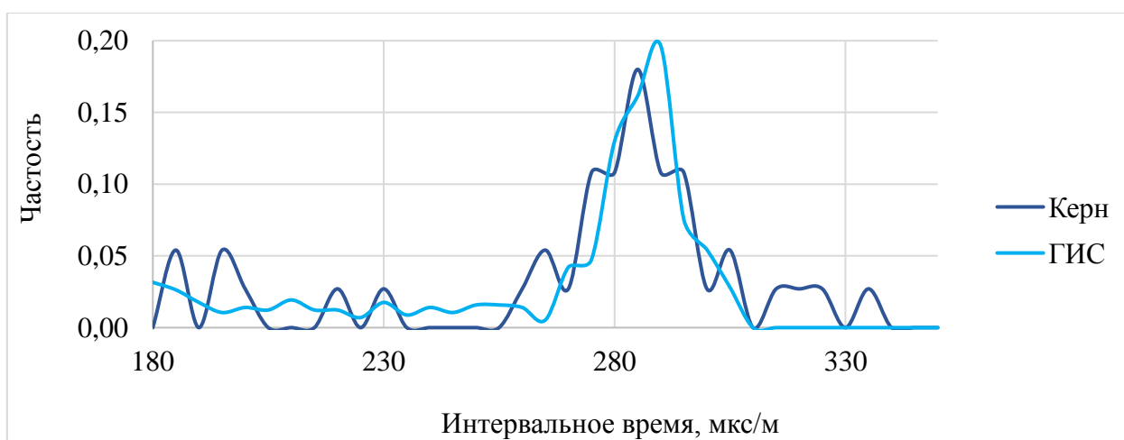
Рисунок 3.3.1. Сопоставление кривых распределения значений интервального времени \Delta T , исходных по данным ГИС и замеренных на керне
