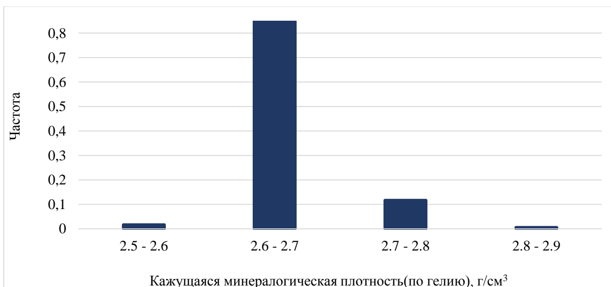
Рисунок 4.3.8. Распределение минералогической плотности пород
