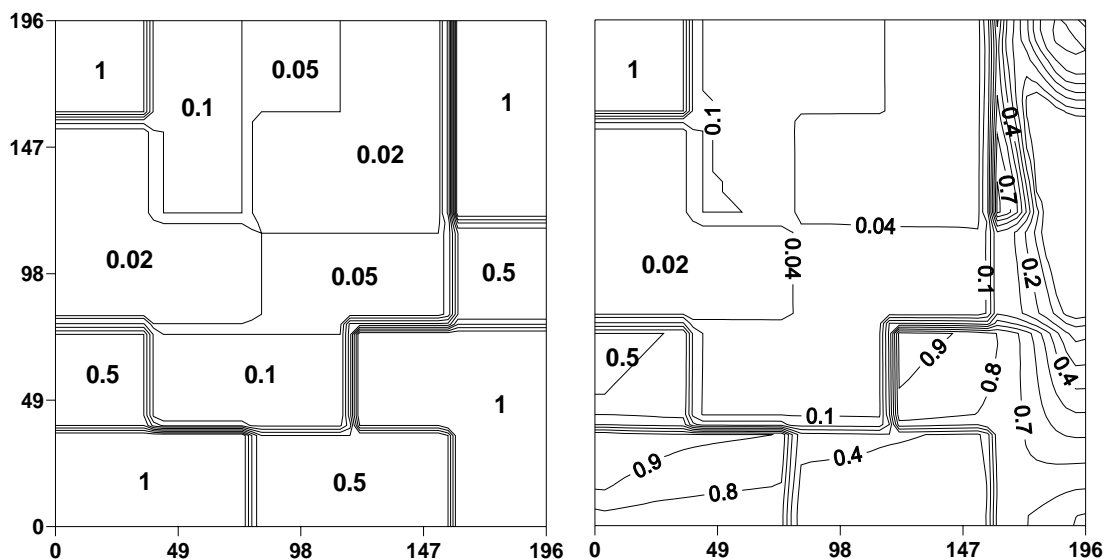
Рис. 4. Проницаемость пласта: слева – без воздействия ПДС, справа – после.
