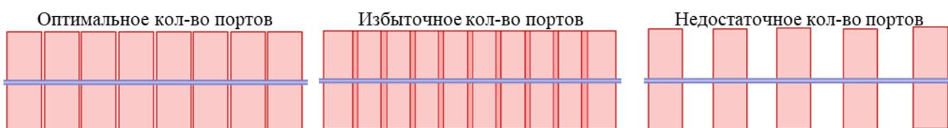
Рис. 5.4. Схематичное расположение портов ГРП в горизонтальной скважине
