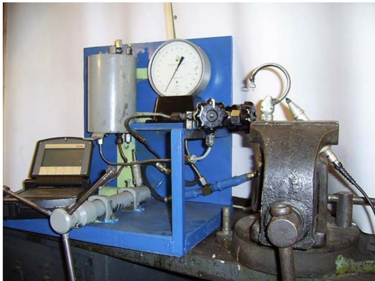
Рис.17. Установка для измерения вибраций
