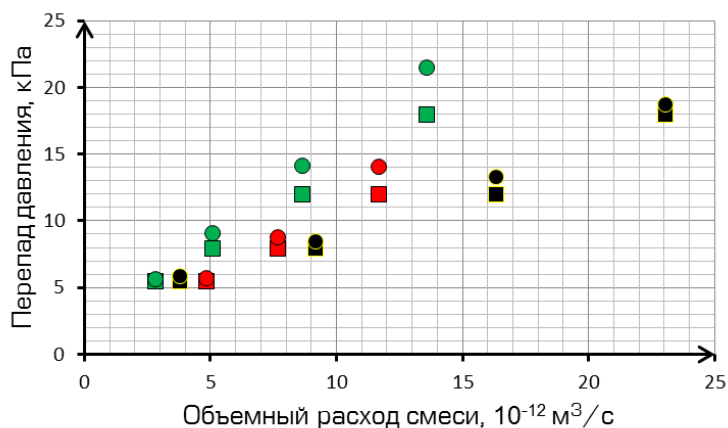
Рис. 6. Сравнение результатов расчетов с использованием ANSYS Fluent и представленной модели
