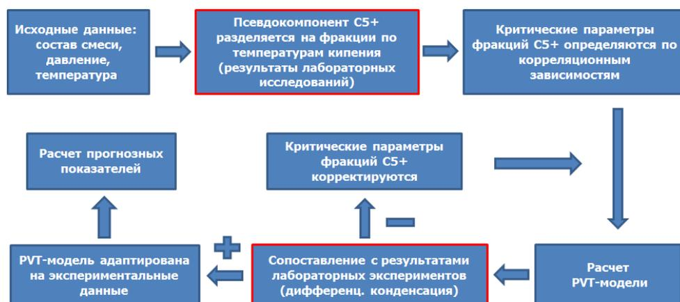
Рис. 2. Классический алгоритм расчета фазового равновесия многокомпонентных углеводородных систем
