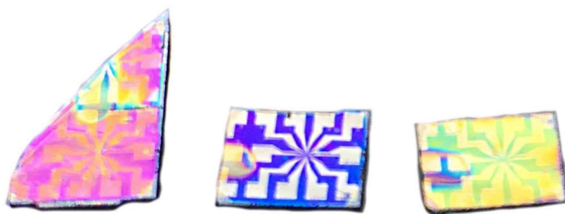
Рис. 2. Образцы мемристорных кроссбаров на основе пленки оксида титана
