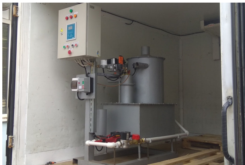
Рис. 5. Фото опытного образца КПН мощностью 100 кВт
