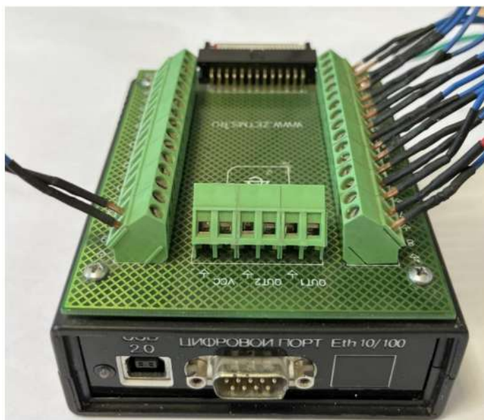
Рис. 2.11. Аналого-цифровой преобразователь ZET 220 с девятью подключенными дифференциальными термопарами
