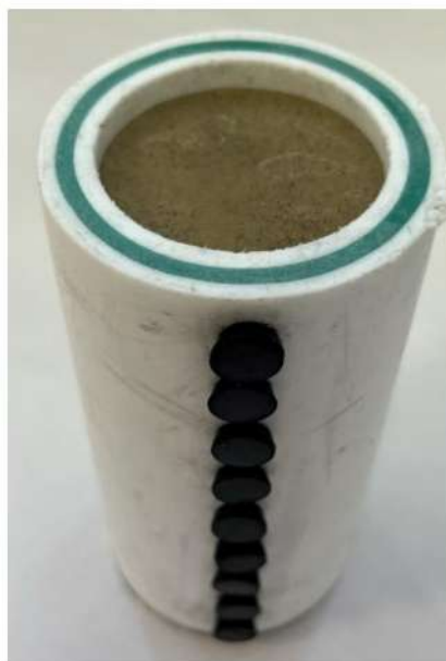
Рис. 2.21. Уплотненный грунт в рабочей камере измерительной ячейки
