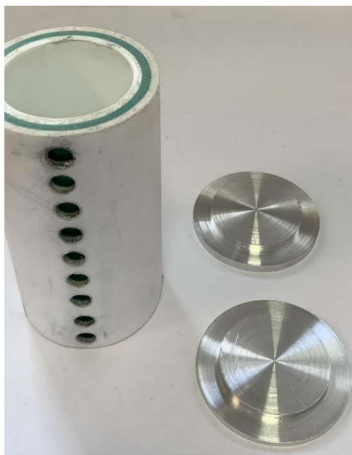
Рис. 2.4. Толстостенный полипропиленовый цилиндр и торцевые алюминиевые диски
