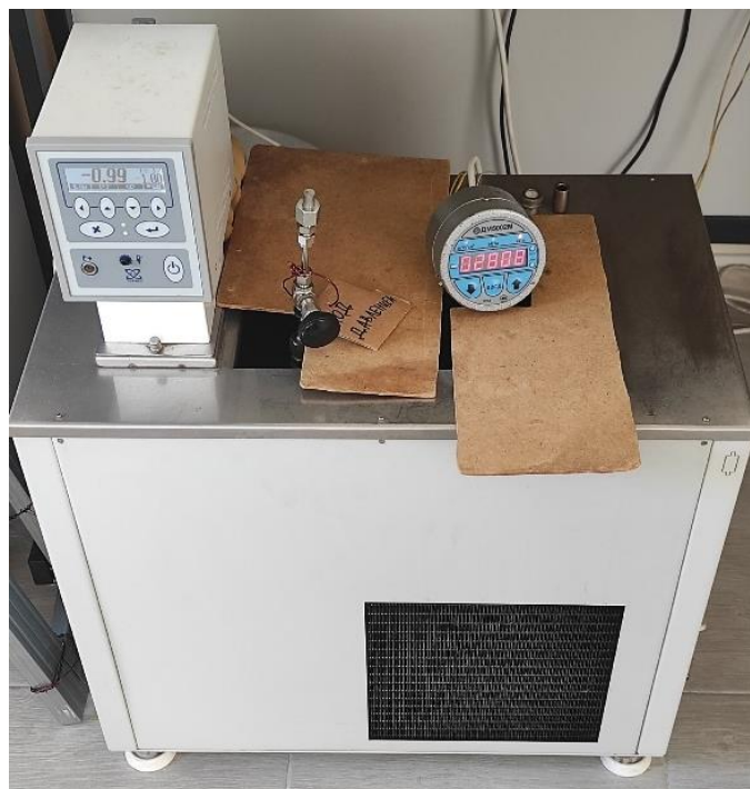
Рис. 2.7. Реактор высокого давления объемом 50 \text{ см}^3
