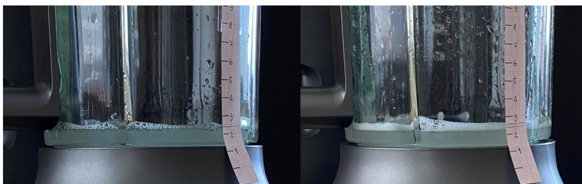
Рис. 15. Процесс пенообразования водного раствора соевого лецитина концентрации 0,5 мас.%. Кратность пены – 0,8
