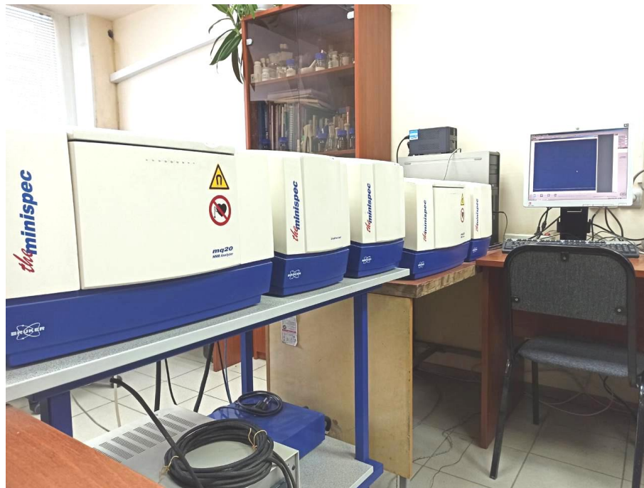
Рис. 10. Фото ЯМР релаксометра газогидратной лаборатории ИКЗ ТюмНЦ СО РАН
