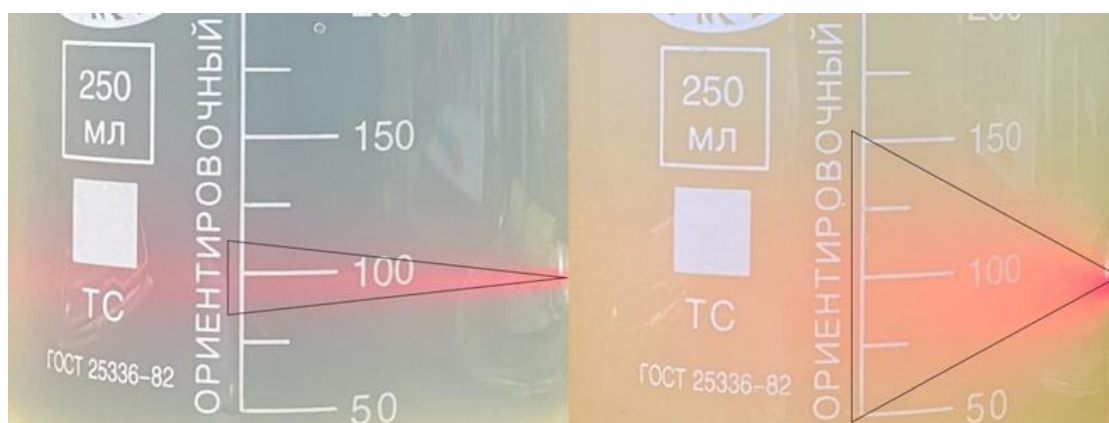
Рис. 7. Оптические свойства (конус Фарадея-Тиндаля) коллоидных растворов на примере водного раствора соевого лецитина с концентрацией а) – 0,1 мас.% и б) – 0,5 мас.%
