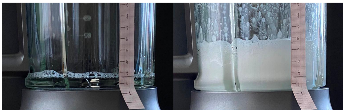
Рис. 14. Процесс пенообразования водного раствора додецилсульфат натрия концентрации 0,1 мас.%. Кратность пены – 14,6.
