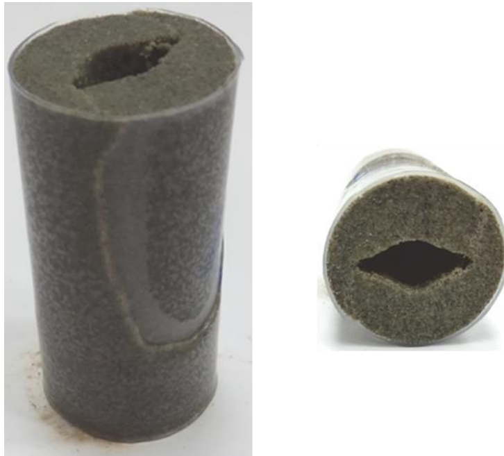
Рис. 9. Образец керна после теста на полом цилиндре
