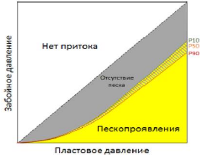
Рис. 4. Карта прогноза выноса твердой фазы в зависимости от «забойное давление-пластовое давление» для модели Вейнгартена и Перкинса
