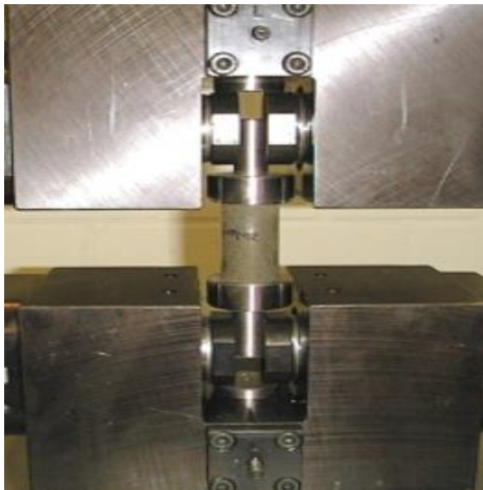
Рис. 6. Схематическая иллюстрация определения прочности керна при одноосном сжатии
