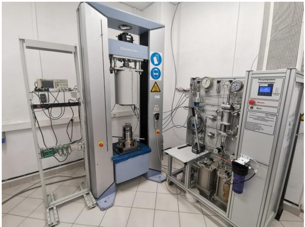
Рис. 7. Установка «SHIMADZU AG-300 kN» оборудована кернодержателем с гидравлическим механизмом создания обжимного давления, таким образом создание осевой нагрузки меньше обжимного давления невозможно
