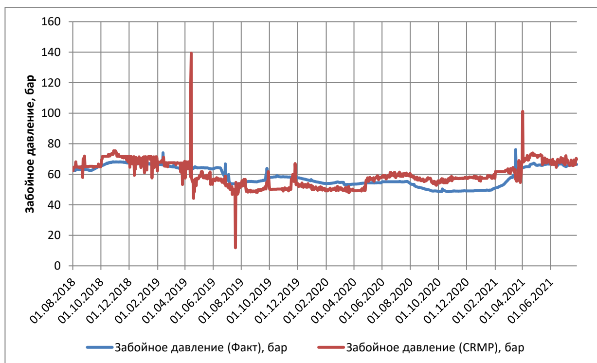
Рисунок 20 - Результаты расчета обратной CRMP-модели для P_{заб} скважины WU_6
