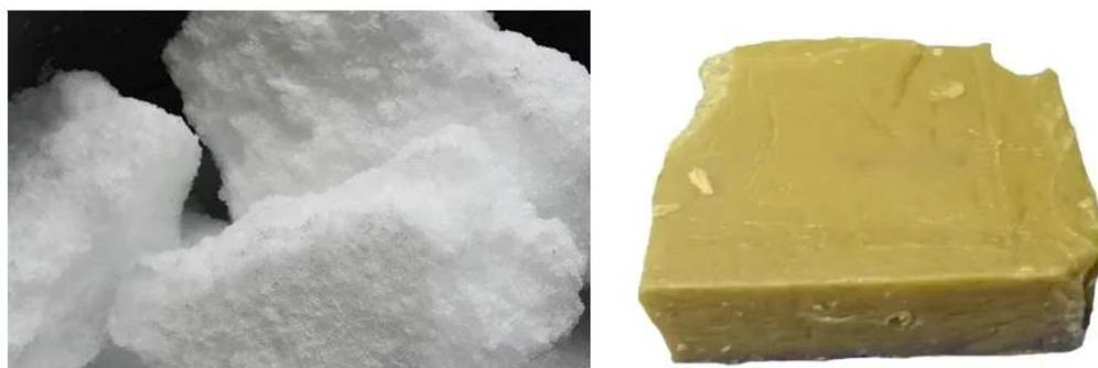
Рис. 1.1.6. Вид плотного (слева) и мелкокристаллического (справа) парафина
