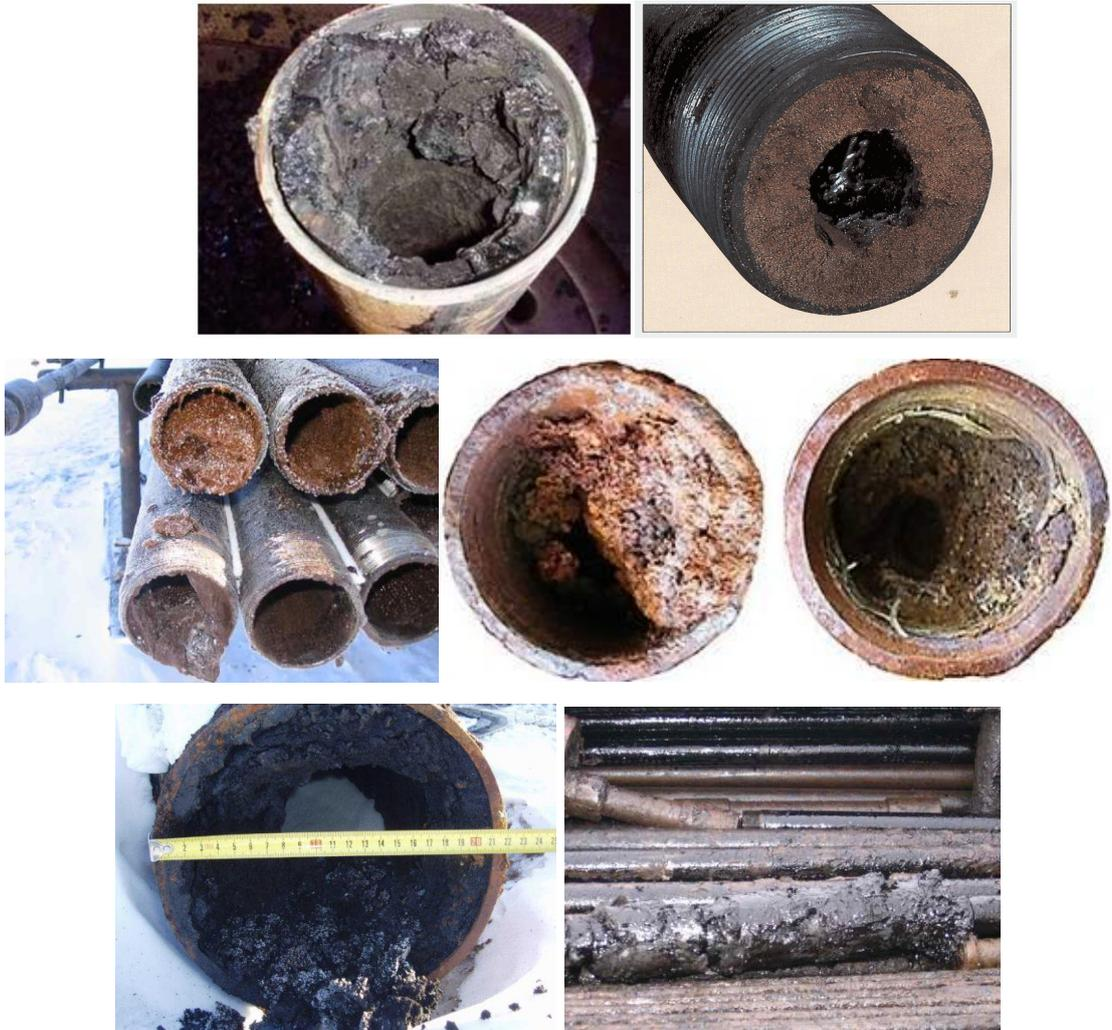
Рис. 1.2.1. Общий вид АСПО в трубе
