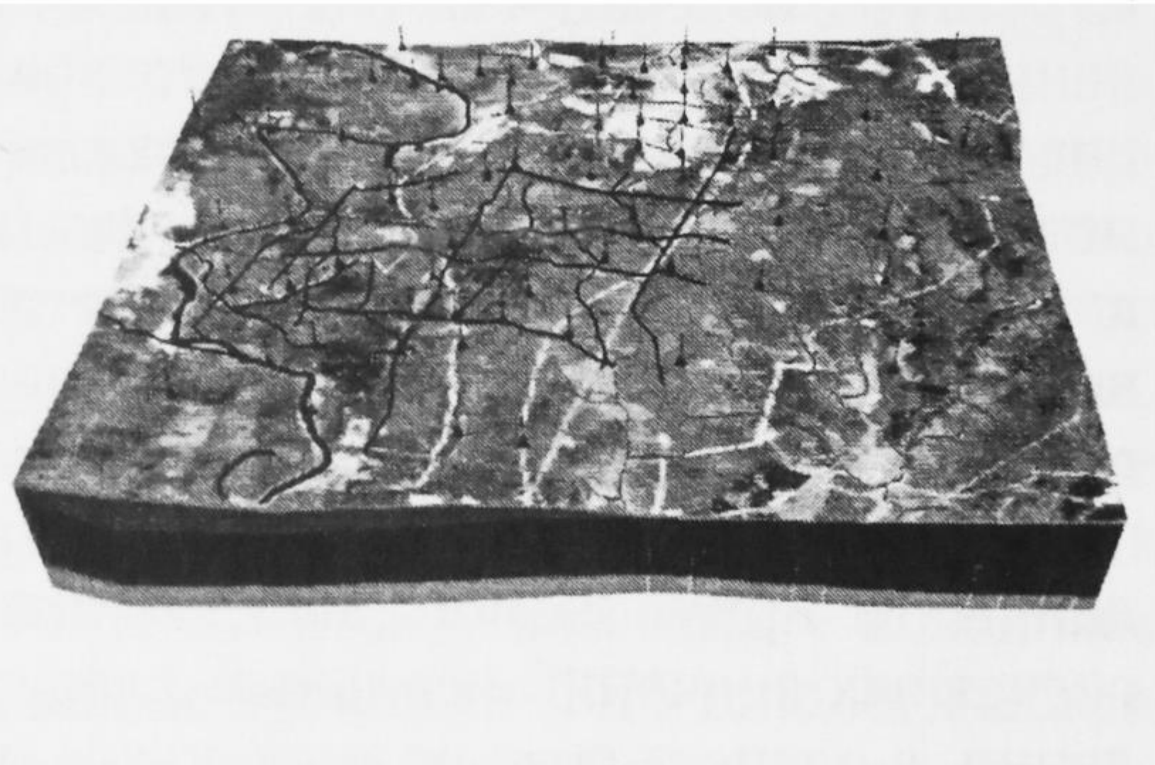
Рис. 3. Структурная модель разреза надсолевой толщи по скважинным данным с учетом топографии местности
