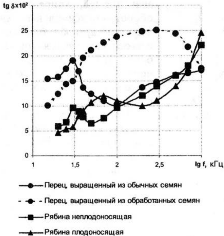
Рис. 5. Частотная зависимость \operatorname{tg} \delta листьев
