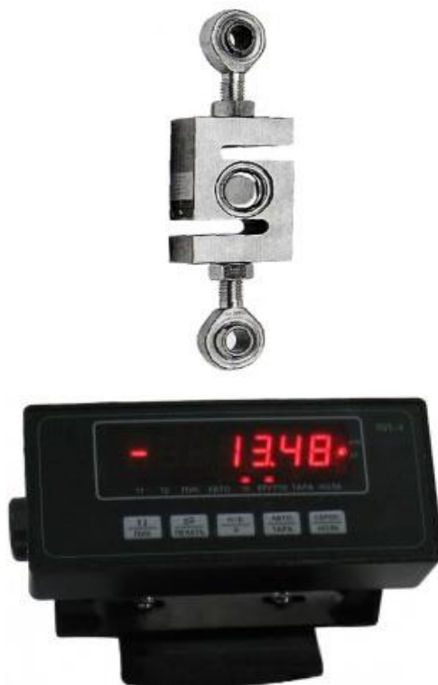
Рис. 1 – Динамометр для оценки силовых способностей армрестлеров
